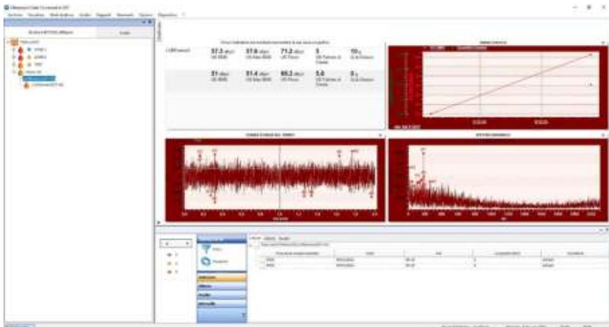
Due misurazioni dinamiche vengono raccolte durante la lettura iniziale e finale del processo di lubrificazione, descrivendo così le condizioni del cuscinetto prima e dopo il processo di rifornimento del grasso. Questo è un grande dato che il tecnico di lubrificazione fornisce direttamente al team di Condition Monitoring.
