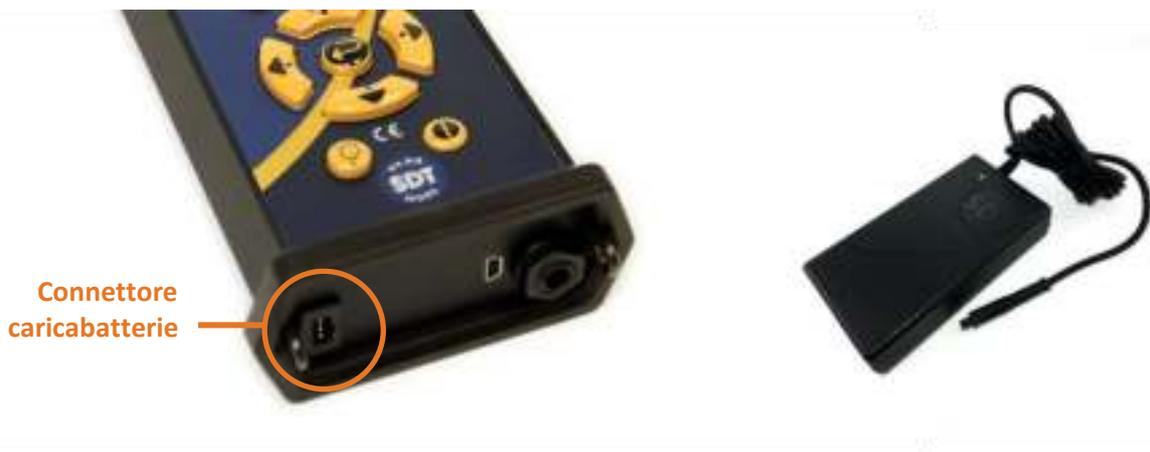
Il tempo di carica generalmente è di 6 ore. Quando il LED del caricatore è continuamente verde, la batteria LUBExpert è completamente carica.
